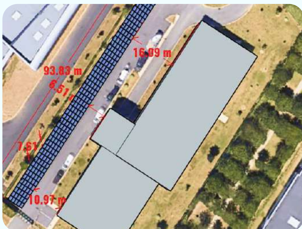
Plan d'implantation des panneaux solaires à Tigery
